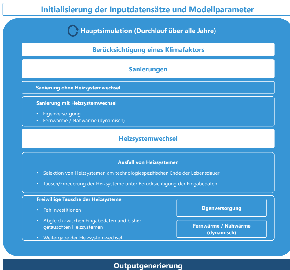
Abbildung 3-2: Schematische Darstellung der Logik der Hauptsimulation des FfE-Wärmetransformationstools mit Einbezug des Input und Output. Für die Simulation der Stadt Stuttgart wird mit Flurstücken statt mit Gebäuden gerechnet. Die Logik ist hiervon nicht betroffen.
