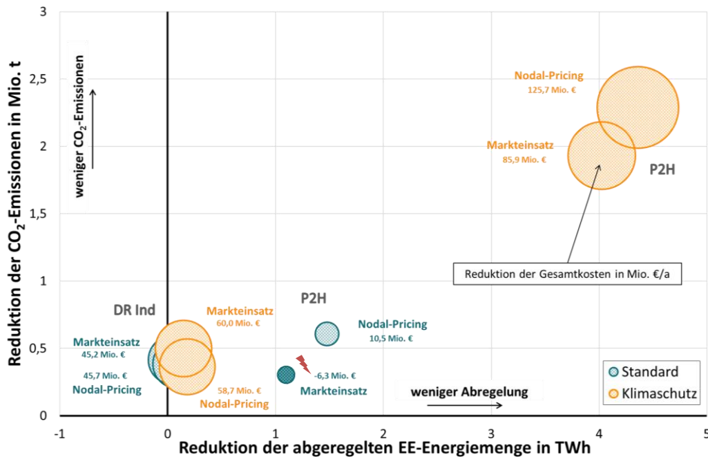
Abbildung 5-25: Emissionsreduktion und Reduktion der abgeregelten EE-Energiemenge bei Optimierung mit den lastflexibilisierenden NoM „P2H“ und „DR Ind“ im Vergleich zur Referenz
