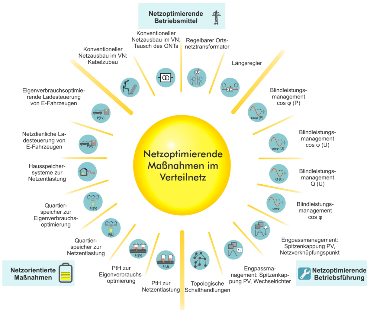
Abbildung 4-1: Netzoptimierende Maßnahmen im Verteilnetz
