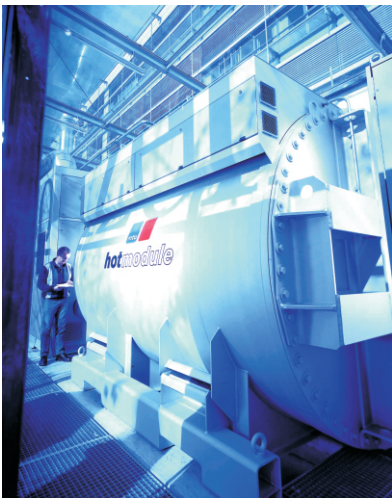
MCFC (hotmodule) Bild: MTU CFC Solutions GmbH
