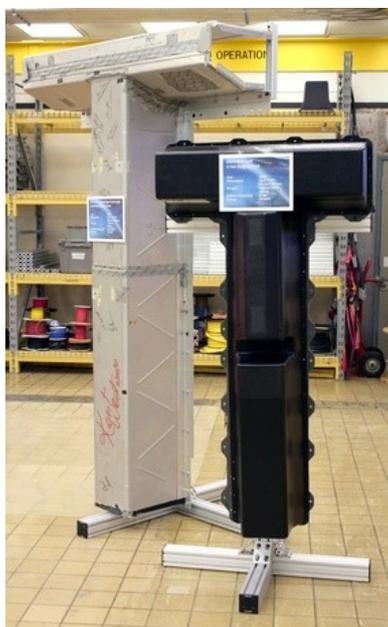
**Abbildung 3-1:** T-Förmige Batterie vom GM Volt /GM/
